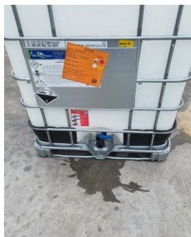
员工工作时发现化学铜废液吨桶因阀门无法关闭造成泄漏
