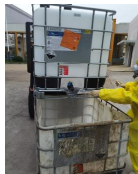
将泄漏的吨桶里面的药液转移到另外的吨桶里面
