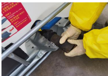
员工穿戴好防护用品后立即用备份堵头去堵塞阀门，但因堵头尺寸不对，无法堵塞
